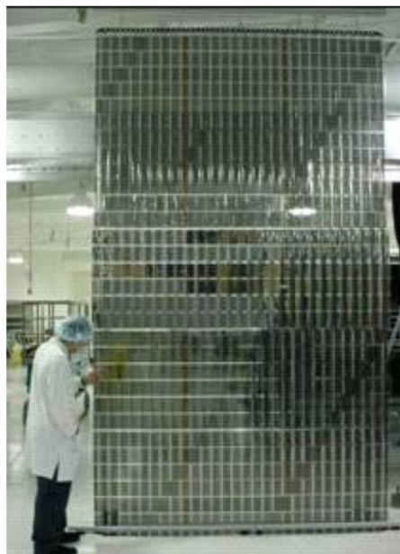
**Figure 5:** 3.75 kW SLASR module
